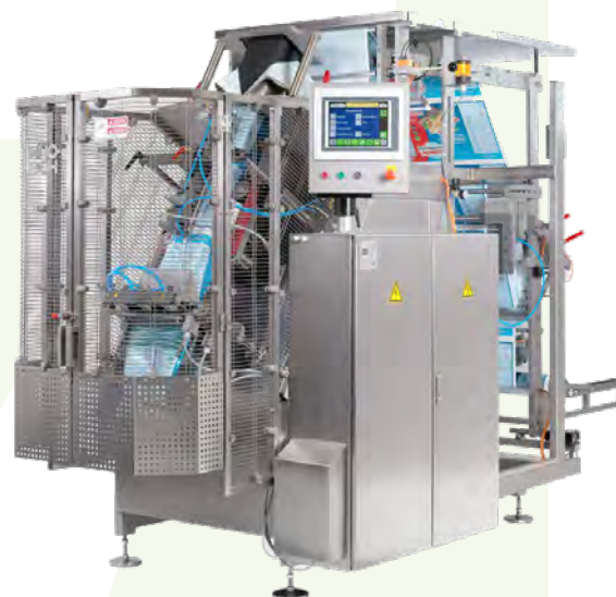
Für das produktschonende Abfüllen bruchempfindlicher Produkte konzipiert: Die inno-tech REVO mit schräg gestelltem Füllrohr.
