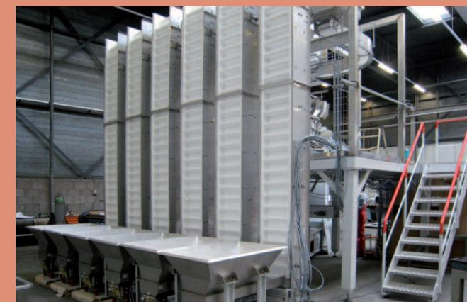
Senkrecht-Elevatoren mit Vibro-Bunker
