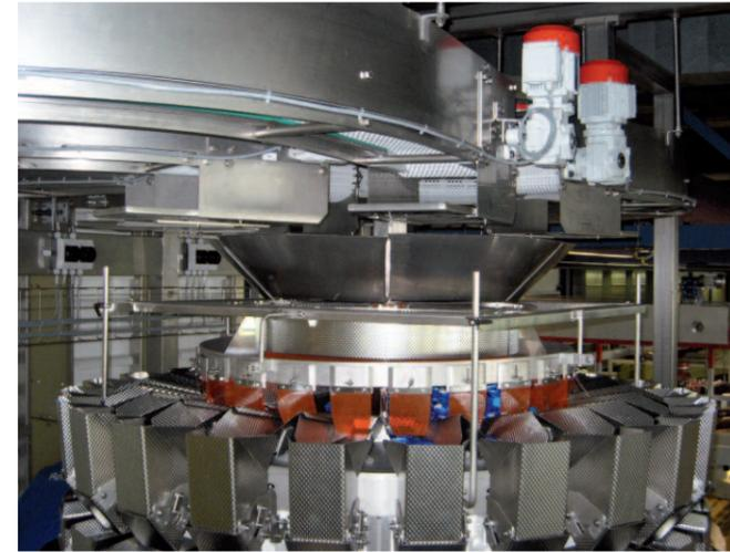
6-fach Mischung, 24-Kopf Waage
