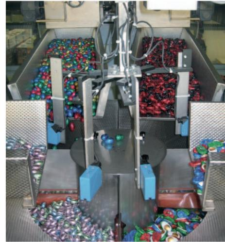
4-fach Mischung, 20 Kopf-Waage
