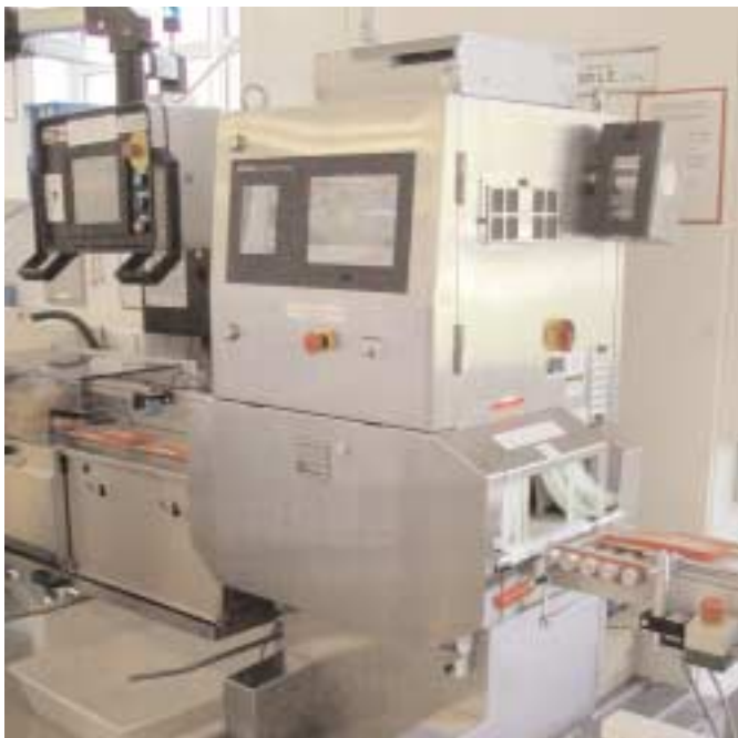
Röntgengerät in Produktionslinie
