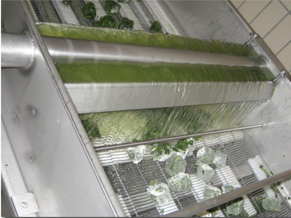
Auf dieser Anlage werden gefrorene Produkte mit Wasser besprüht (glasiert)
