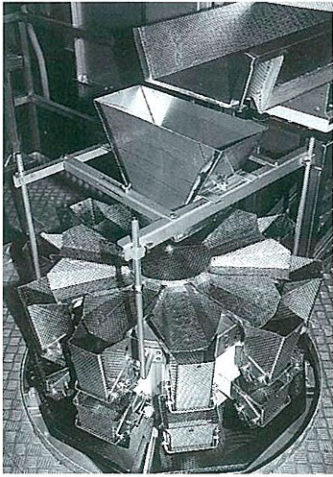
Die Zehn-Kopf-Computerwaage der Gefrier-Wiege und Verpackungsanlage.
