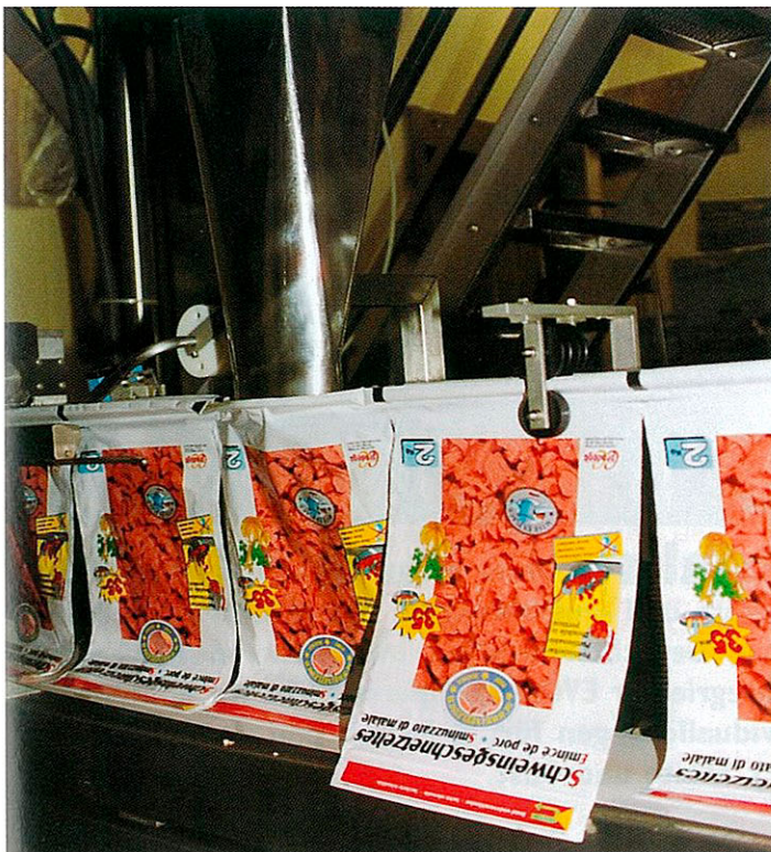
Befüllstation der Joker-Verpackungsmaschine: Ausbuchtungen in den Führungsschienen öffnen die Beutel automatisch.
