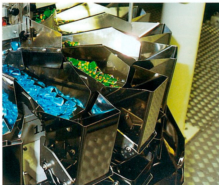
Die Computerwaage mit zwanzig Köpfen verwiegt eine Mischung aus zwei Produkten in festgelegtem Verhältnis.
