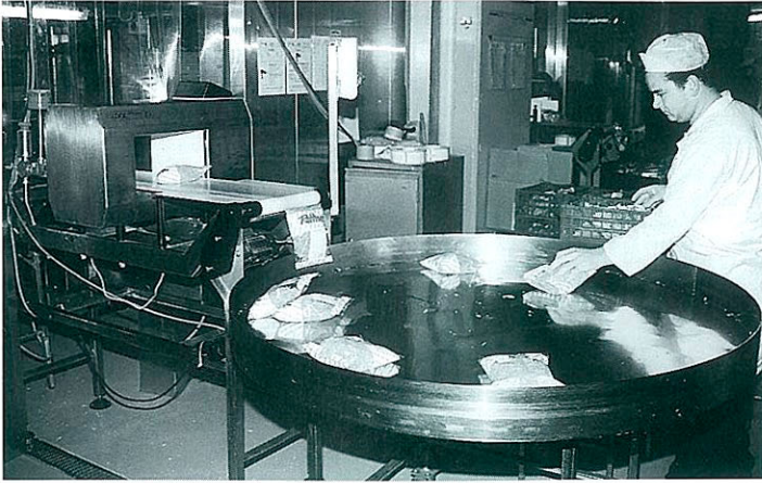
Letzter Check vor der Endverpackung: Metallsuchgerät am Auslauf der Schlauchbeutelmaschinen
